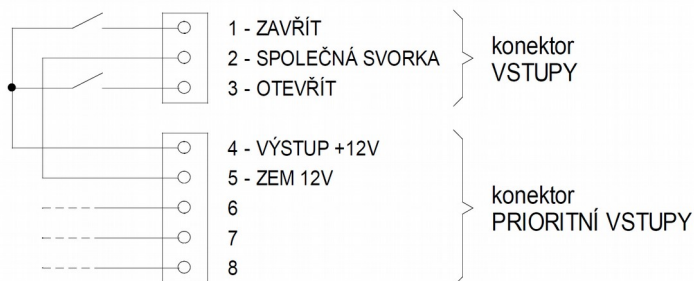
Obr. 5: Připojení řídicích napěťových signálů
