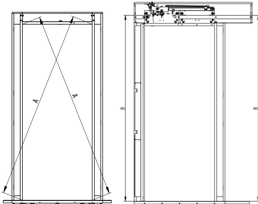
Po montáži šachetní mechaniky se provede montážní měrkou kontrola vzdálenosti mezi vodícím prahem kabinových dveří a vodící lištou šachetní mechaniky – 56 mm.
