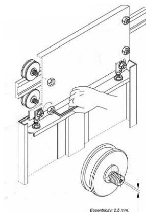
V každém nástupišti se pak musí seřídít kladky hákové uzávěrky dle obrázku a otvírače kabinových dveří tak, aby při otevírání dveří nebyla pohyblivá část hákové uzávěrky otvíračem přetlačována a zároveň, aby
